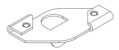
Oberfläche: ZEICHNUNG NICHT SKALIEREN Material: GEWICHT: SIGNATUR DATUM BENENNUNG: NAME Deckenclip mit Öse, ø5,5mm, weiß, für Rasterdecken, Schienenbreite 24mm GEZEICHNET GEPRÜFT GENEHMIGT PRODUKTION Wächtersbacherstraße 86 60386 Frankfurt am Main Tel.:+49 (0) 69-173094490 www.mb-licht.de QUALITÄT ZEICHNUNGSNR. A4 info@mb-licht.de
