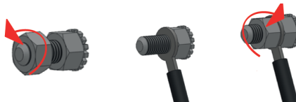
Rys. 4. Podłączenie urządzenia do instalacji wyrównującej potencjały elektryczne.
