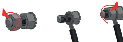
Abb. 4 Anschluss des Geräts an das elektrische Potentialausgleichssystem.
